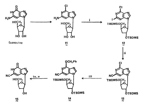
(i) see 1→5; (ii) n-Bu<sub>3</sub>SnCN, Pd(PPh<sub>3</sub>)<sub>4</sub>, Toluene<sub>3</sub> Δ; (iii) PhCH<sub>2</sub>OH,
